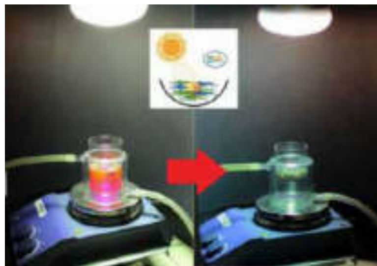
PROGETTO SUNFLOAT, APPARATO SPERIMENTALE. SULLA SINISTRA ACQUA INQUINATA PRIMA DEL TRATTAMENTO FOTOCATALITICO. IL TEST VIENE EFFETTUATO MEDIANTE L'AUSILIO DI UNA LAMPADA SOLARE E CATALIZZATORE SUPPORTATO SU MATERIALE GALLEGGIANTE.
