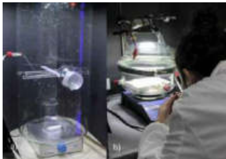
A) REATTORE PER LA DEGRADAZIONE DI OSSIDI DI AZOTO (NO x ) IN FASE GAS; B) REATTORE PER LA DEGRADAZIONE DI COMPOSTI ORGANICI VOLATILI (VOCs) IN FASE GAS. IN ENTRAMBI I CASI IL CATALIZZATORE È SUPPORTATO SU LASTRE DI VETRO E IRRAGGIATO DA LUCE LED.
